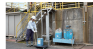
改善事例：階上のタンク置場を階下へ移動台車の活用で搬送の負担を軽減
